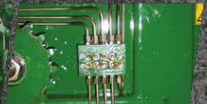
Zentral verrohrte Schmierleisten
