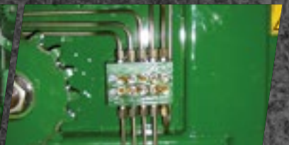
Zentral verrohrte Schmier- leisten
